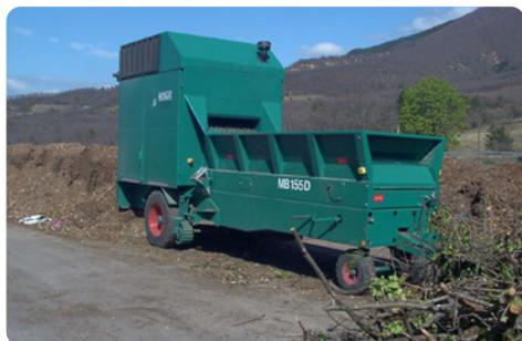
Exemple de **broyeur industriel** à utilisation fixe ou mobile sur semi-remorque de plus de 100 chevaux à marteaux
