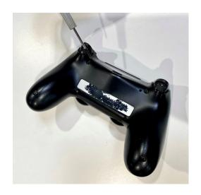
Ensuite, déclipsez la coque inférieure du châssis de la manette à l'aide du levier en nylon.
