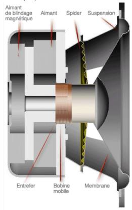
Pour mettre l'air en mouvement, le haut-parleur utilise une membrane en carton. A l'arrière de cette membrane est collée une bobine mobile. L'ensemble de ces pièces en mouvement s'appelle « l'équipage mobile ».
