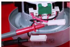
Ensuite, on met les fiches du multimètre, dans les connecteurs du moteur.
