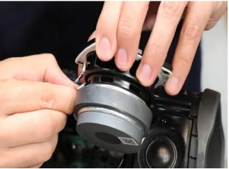
Il ne restera plus qu'a mettre le nouvel haut-parleur au même endroit en prennant soin de le replacer et le rebrancher correctement. Pour finir, visser les 4 vis qui servent à maintenir le dispositif en place dans l'appareil.
