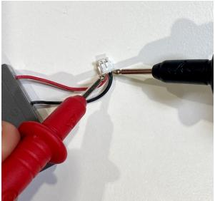
Quand la batterie est chargé à 100%, le résultat indiqué doit être de 4,25V, lorsqu'elle est totalement déchargée, son niveau doit être compris entre 2V et 2,20V.
