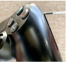
ATTENTION! La coque arrière est toujours reliée par une nappe. Déconnectez la nappe du connecteur de charge en tirant délicatement dessus pour libérer la coque inférieure.
