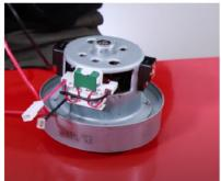
A l'intérieur, il y une partie qui est fixe, qui s'appelle le stator, et une autre en cuivre qui tourne, qui s'appelle le rotor.
