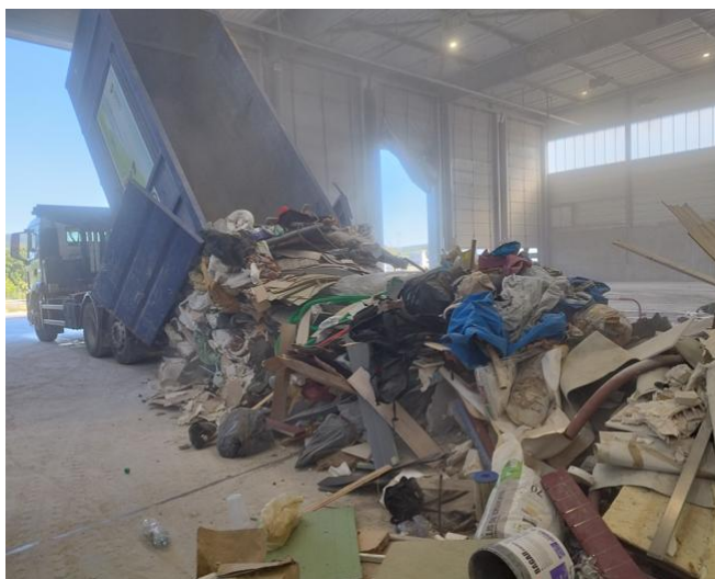
Déversement de la benne au sol
