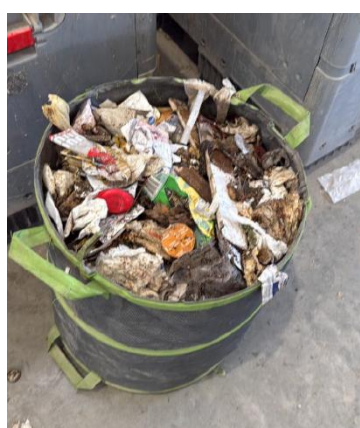
Prélèvement du quart pour criblages sur 50mm et 20mm
