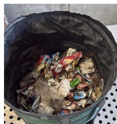
Prélèvement des 7kg pour tri et criblage sur 20mm
