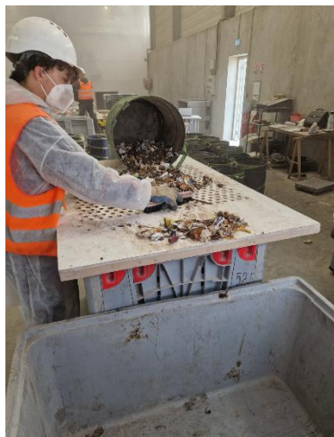
Criblage sur la maille de 20mm
