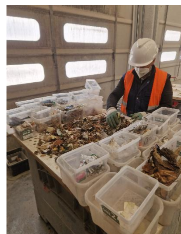
Criblage et tri sur la maille de 20mm
